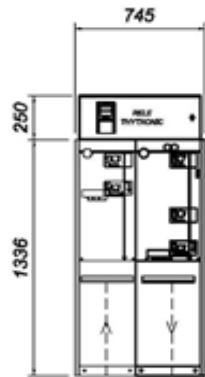
CELDA LLEGADA Y SALIDA (I - V+)
